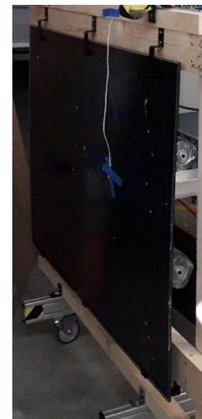
Versuchsstand zur Bestimmung der Resttragfähigkeit unter erhöhter Kerntemperatur Din 18008
